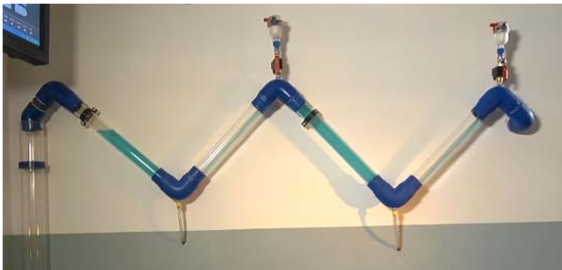
Figura 3: Simulação em laboratório A.R.I.. Podemos ver que no trecho descendente com a presença do ar, o escoamento ocupa parcialmente a seção da tubulação, escoamento realiza esforço.
